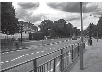
Podem ser utilizadas marcas viárias para indicar a aproximação de uma faixa de pedestres ou de outras mudanças nas condições de trânsito, onde os condutores devem reduzir a velocidade para o bem da segurança. Pode ser utilizada uma simples linha branca central interrompida além de linhas em zigue-zague na borda da pista, na chegada e na saída do cruzamento (devidamente indicadas) para alertar os condutores que estão se aproximando de um cruzamento.
